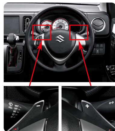
↑ スポーツタイプの車に装備されていることが多いパドルシフト。ハンドル後部に装着されていることが多い。
