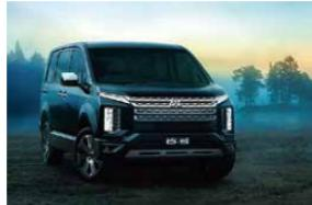
ミニバンながら、悪路で障害物を乗り越えて通過するためのアプローチアングル(21.0°)、ディバーチャーアングル(23.0°)、最低地上高(185mm)というスペックを確保しているので、かなりのラフロードでも走行することができます。
